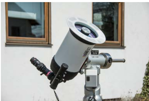
Der SunDancer II an einem 8" Triband SC mit in die Schmidtplatte integriertem D-ERF
