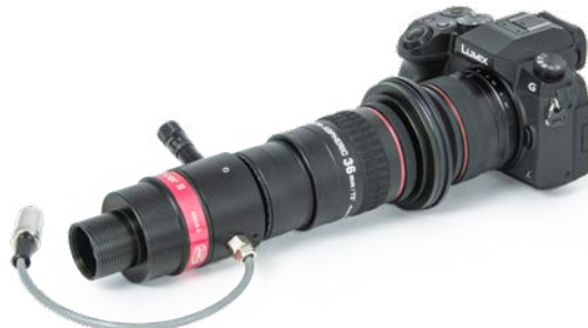
Auch das geht prinzipiell: Eine MFT-Kamera mit 12mm-Objektiv überblickt fast das gesamte Bildfeld eines Hyperion 36mm-Okulars.
