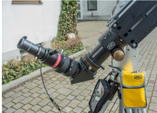
Der SunDancer II am Teleskop mit Zenitspiegel; Kontrollbox und Netzteil sind in der gelben Tasche.
