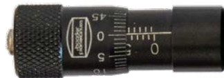
Mit der Mikrometerschraube kann der Filter in den blaue Flügel der H-alpha-Linie gekippt werden.
