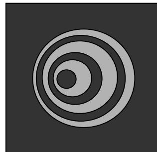
Figur 4. Sternenmuster eines nicht kollimierten Teleskops.
